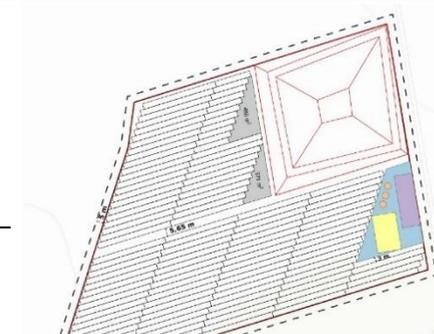
beieinanderstehen. Südlich des Speichers das Heizhaus und die Pufferspeicher, westlich zwei Versickerungsbecken für Regenwasser und der Rest mit Solarkollektoren. Aus Platzmangel muss die Solarkollektorfläche etwas verkleinert werden,
